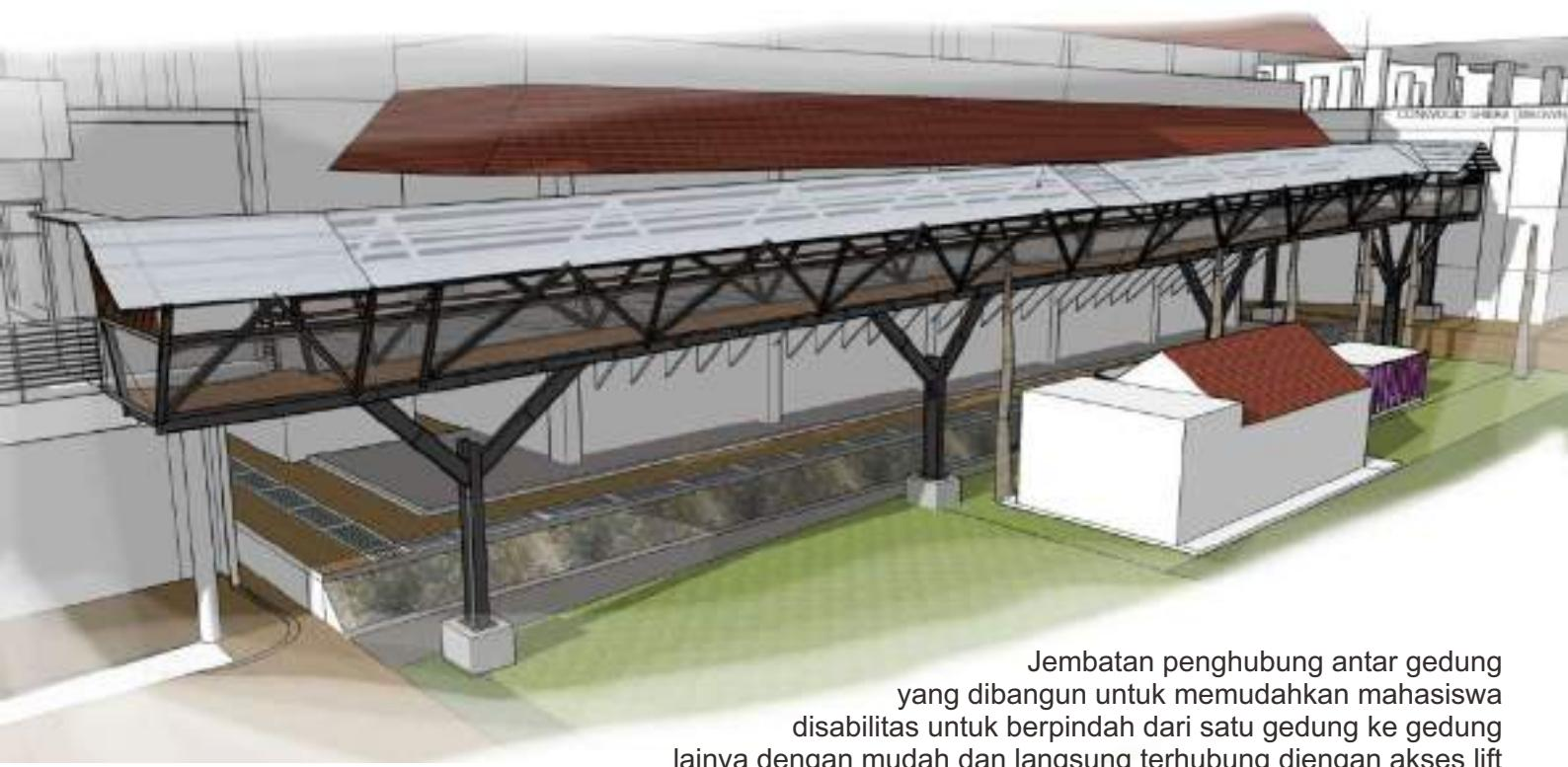
Jembatan penghubung antar gedung yang dibangun untuk memudahkan mahasiswa disabilitas untuk berpindah dari satu gedung ke gedung lainnya dengan mudah dan langsung terhubung diengang akses lift
